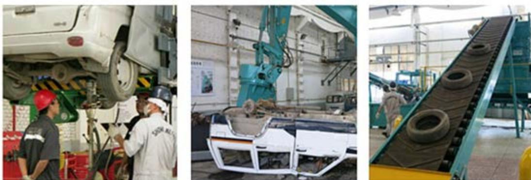
(左)廃液の回収工程、(中)切断機による車体の解体工程、(右)廃タイヤの破碎工程
